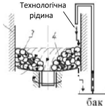
Рисунок 2 – Схема відцентрово-ротаційної обробки деталей «в навал»
