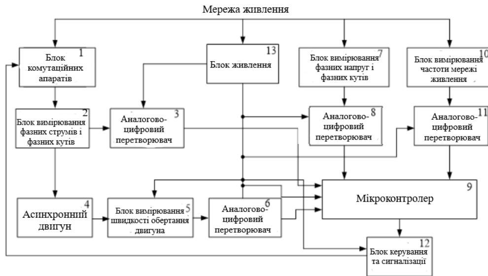
Рисунок 2 – Блок-схема пристрою виявлення початкового моменту виткових замикань в статорних обмотках АД
