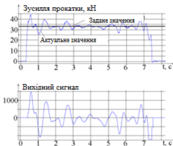
Рисунок 1 – Ілюстрація роботи системи противигином робочих валків
