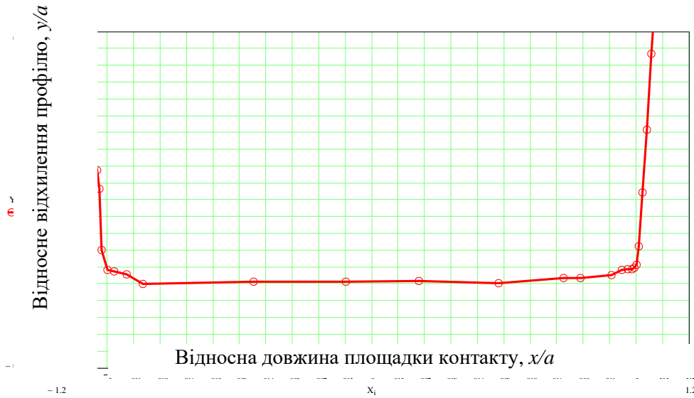
Рисунок 2 – Змінення профілю зразка в відносних координатах, де a – полуширина площадки контакту
