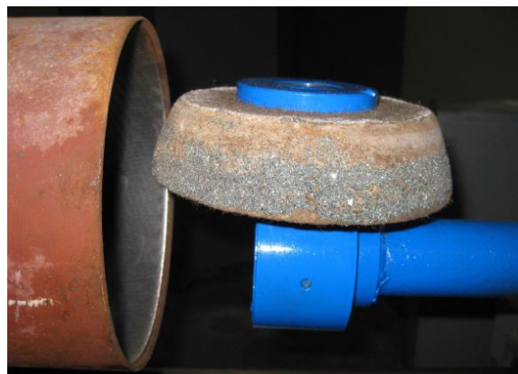
Рисунок 3 – Схема внутрішнього шліфування
