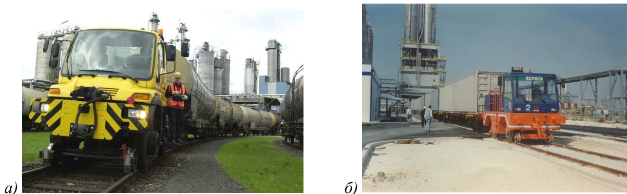
Рисунок 1 – Тяговий засіб на комбінованому ході: а – фірми «Zweiweg»; б – фірми «Zephir»
