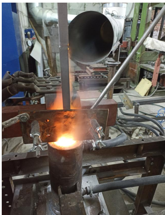
Рисунок 2 – Електрошлакове виплавлення вторинного титану
