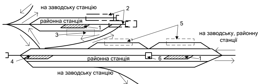
Рисунок 2 – Схема транспортного обслуговування АФ залізничним транспортом
