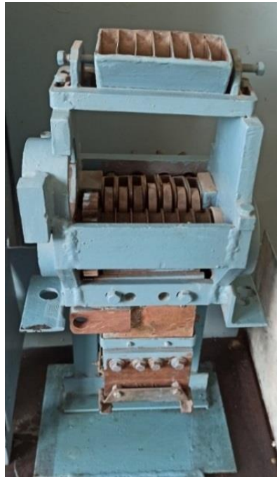
Рисунок 3 – Пристрій для подачі семи порошкових електродів
