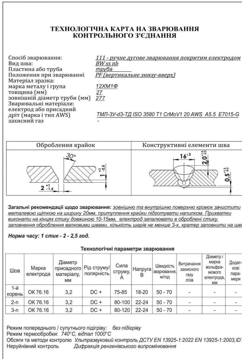
Рисунок 1 – Характеристики зварного з'єднання та технологічні параметри
