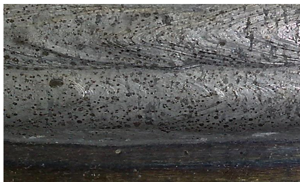
Рисунок 1 – Наплавлений метал порошковим дротом 14X12Г12СТ під флюсом АН-26П
