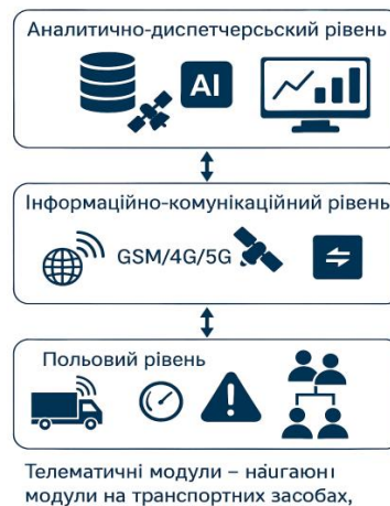
Рисунок 2 – Трирівнева архітектура автоматизованої системи диспетчерського управління
