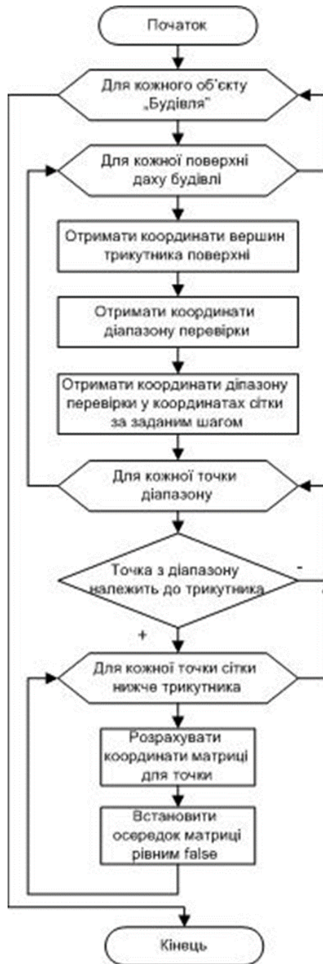
Рисунок 3 – Узагальнена блок-схема алгоритму побудови моделі мапи середовища
