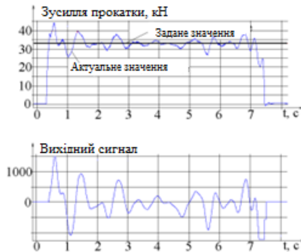
Рисунок 1 – Ілюстрація роботи системи противигином робочих валків
