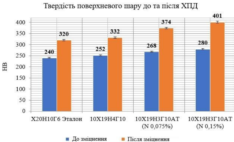
Рисунок 3 – Результати зміни твердості наплавлення випробуваними порошковими дротами до та після ХПД
