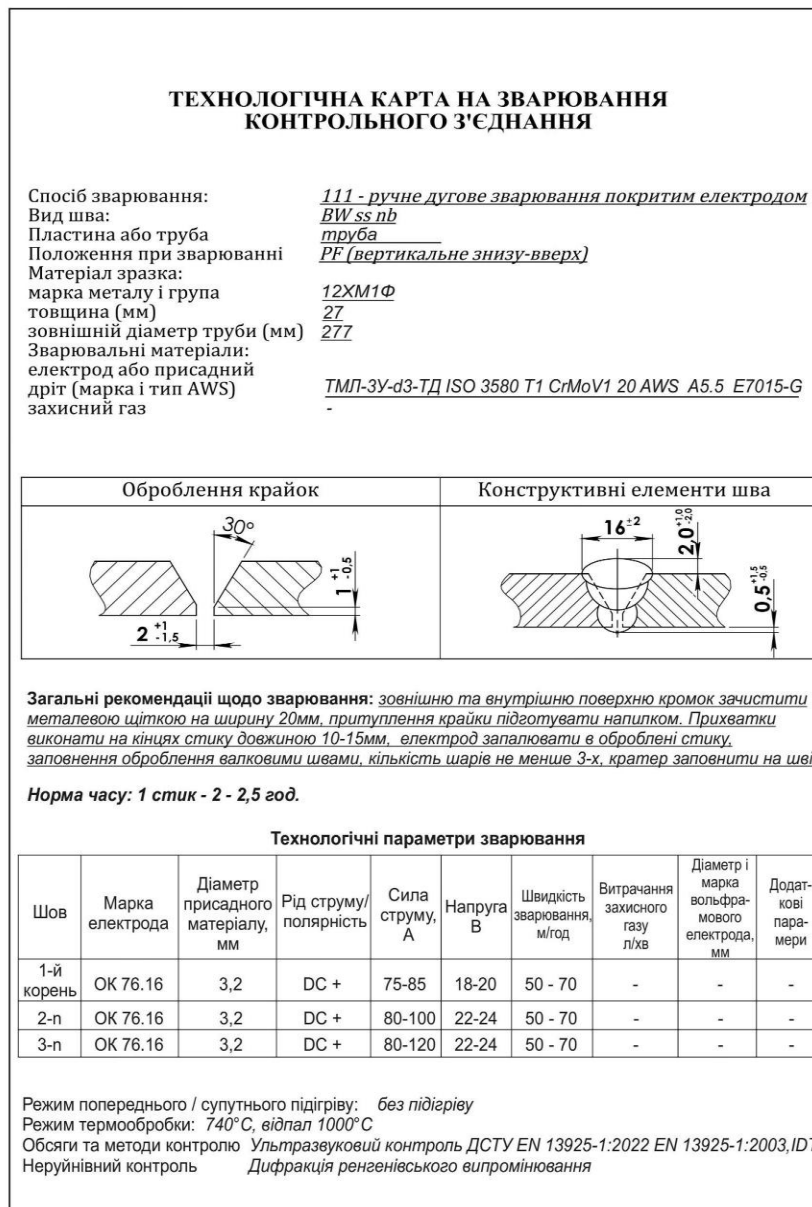
Рисунок 1 – Характеристики зварного з'єднання та технологічні параметри
