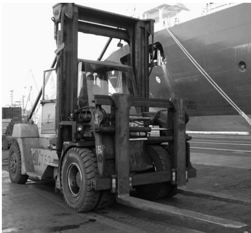
Рисунок 1 – Фронтальний автотранспортер з вантажопідіймником дворадної конструкції
