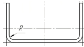
Рисунок 2 – Округленість між полкою та стійками в холодногнутому швелері
