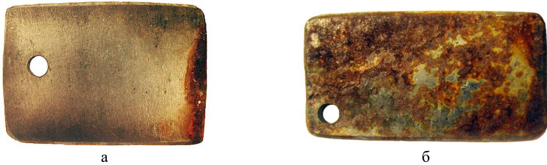
а – випробування у міському середовищі; б – прискорені випробування у камері сольового туману
