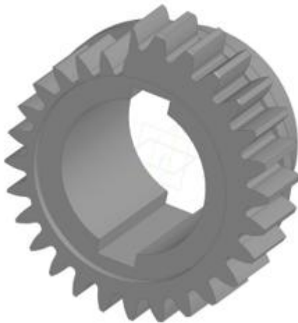
Рисунок 5 – 3D модель розробки ведучої шестерня зі змінним значенням ділительного кола зубців у парі з нерухомою зубчастою рейкою для забезпечення природнього процесу холодної пильгерної прокатки труб
