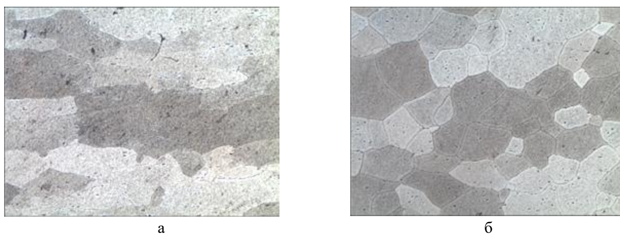
а – нагартований стан; б – рекристалізація при 950 °С
